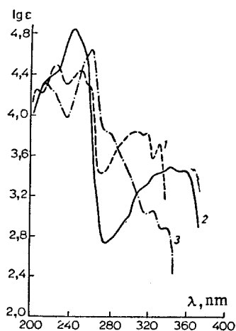
Fig. 1. UV spectra of the benzindoles in ethanol: 1) 4,5-benzindole; 2) 5,6-benzindole; 3) 6,7-benzindole.
